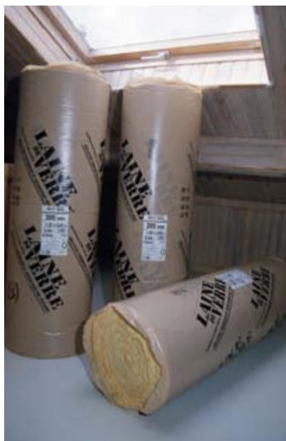
Pour l'isolation par l'intérieur, les isolants sont en laine minérale, PSE, PSX, PUR.
