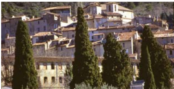
Les murs de pierre épais des maisons traditionnelles provençales limitent les surchauffes en été.
