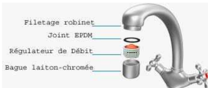
Mise en place d'un mousseur sur un robinet. Source: Ecoverl
